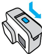
2. 將相機電源關閉，然後將 SD 記憶卡以標籤面向電池槽的方向插入記憶卡插槽。
